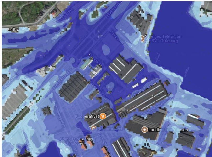
Figur 14-5: Effekter vid högvatten i hav med vattennivå +2,3 m motsvarande en 200 års-händelse omkring år 2070, vilket gäller som utgångspunkt för utvärdering av skyddsbehov på medellång sikt.
