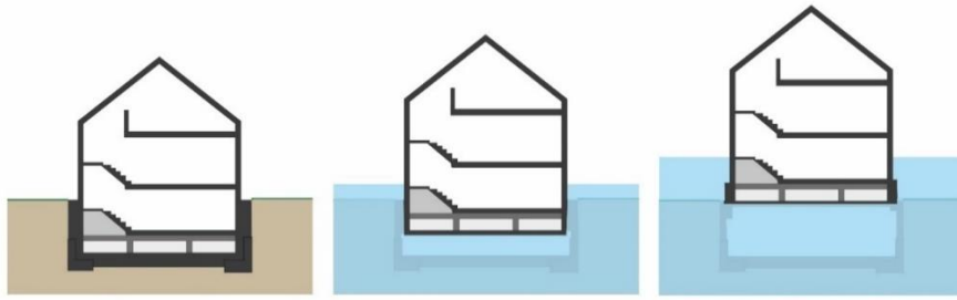
Figur 10-2: Amfibehus som använder vattnets lyftkraft som lyfter huset under översvämningen. Modifierad från (Baca Architects, 2014).
